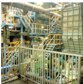
写真1：破砕機(右)で砕き、磁力選別機(中央の四角い装置)で金属を除去する。
